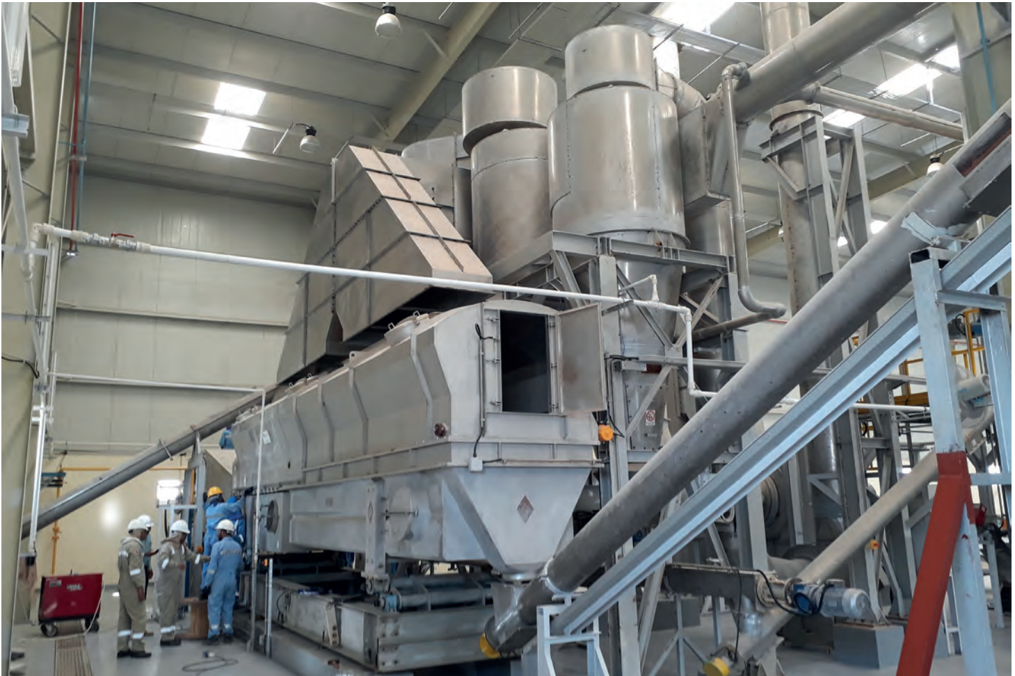
Bij een wervelbeddroger – zoals deze van Tema Process – wordt hete lucht van onderaf door een geperforeerde en schuddende distributieplaat geblazen.
