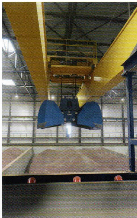
Afb. 4 Een 2,5 tons grijper voor het reclaimen van de bonen
