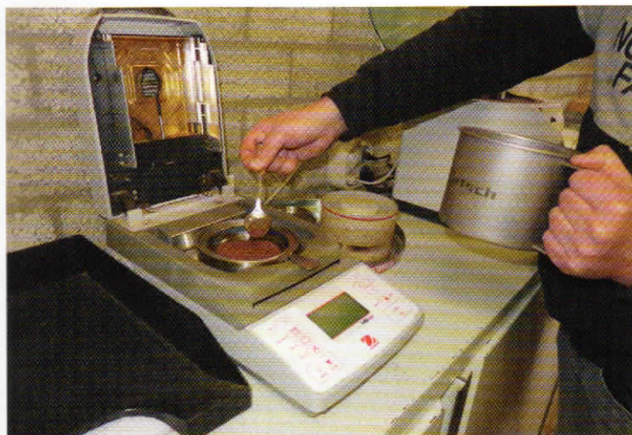
Afb. 4 Vochtbeplating met een Ohaus MB45 analyzer
